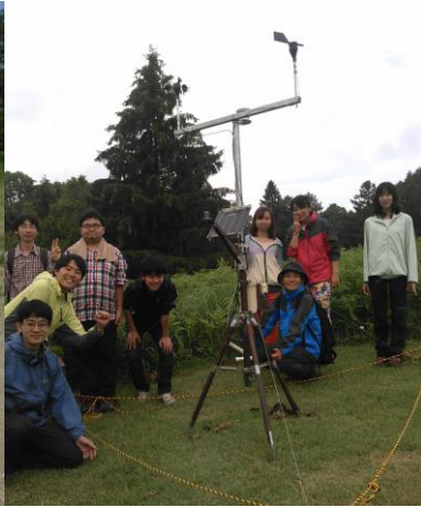
自動気象ステーションによる天候のモニタリング
