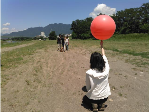
気球（パイバル）を使った谷間の気流観測
