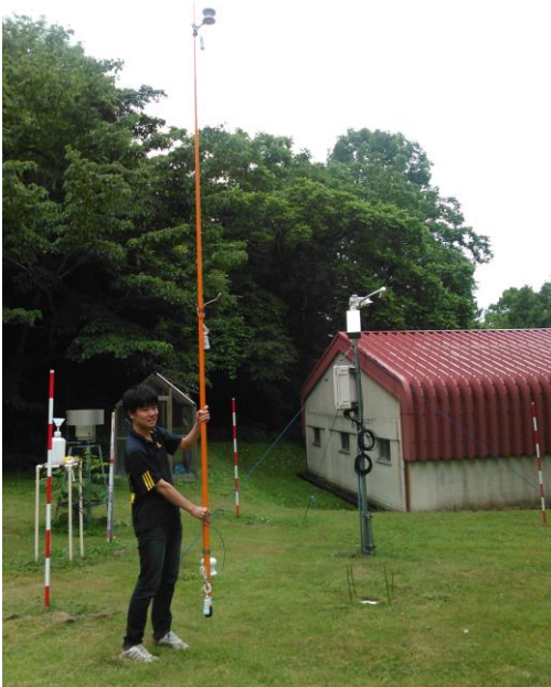
5mポールを利用した気温勾配の移動観測
