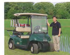
燃料電池を利用した農業用小型ビークルの開発 Development of small, fuel-cell-powered agricultural vehicle
