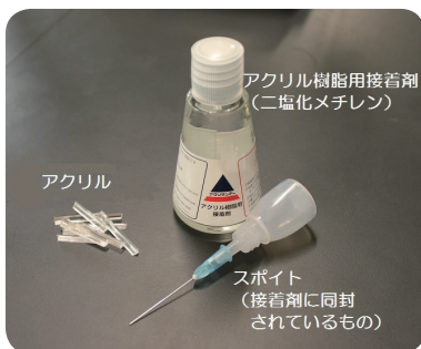
写真1 使用したアクリル樹脂用接着剤とアクリル。ホームセンターで購入できます。
