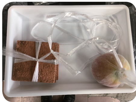
図7：ビニールひもに、ネットに入れたリンゴと重りをつけた釣菌セット
